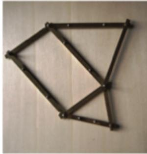
Figura 1. Fotografia del pantografo per la rotazione
